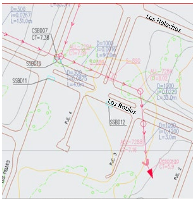
Fuente: Plan Maestro de Aguas Lluvias 2014 Imagen 17. Entubamiento descarga de aguas lluvias, Sector Isla Teja
